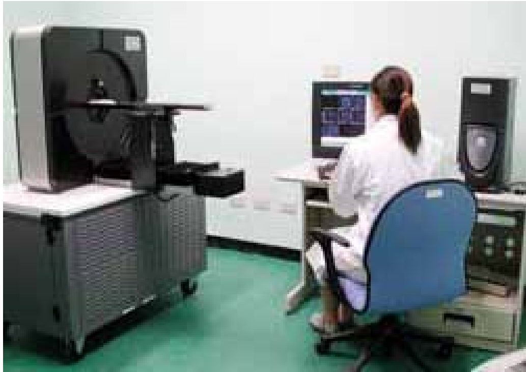
圖一 動物實驗用microPET(由國衛院/核研所共同引進，中心點空間解析度~2mm)
