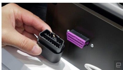
圖 52、Customer-Link Bridge (Dongle) 需插上 OBD II 插槽
