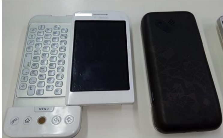
圖 3~2 第一支 T-Mobile 版(樣本)及 Google 版(開發者)的 Android 手機 資料來源：中華電信，本研究整理
