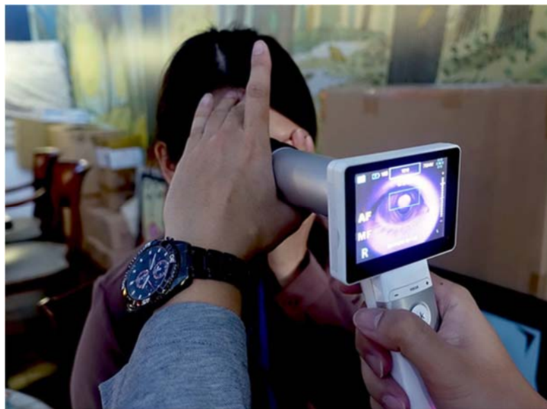
圖 4-4-3 晉弘科技的「全彩手持式數位醫學免散瞳眼底鏡 DEC 200」
